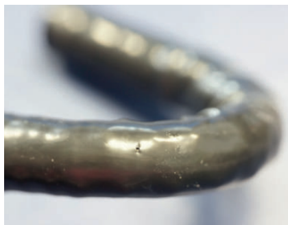
Häufige Schäden an Endoskopen: Abwinklungsmi perforiert.
