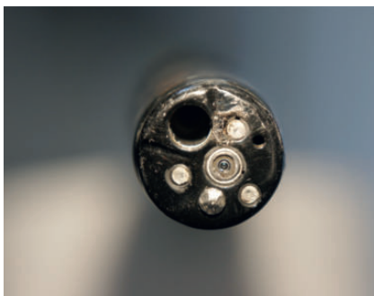
Endkappe verschmort, Objektivfenster angeschlagen.
