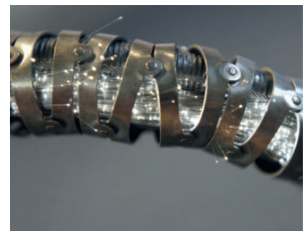
Lichtleiter in Abwinkelungssektion gebrochen.
