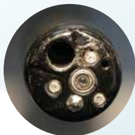
Endkappe verschmort, Objektivfenster angeschlagen
