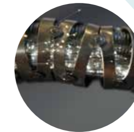
Lichtleiter in Abwinklungssektion gebrochen
